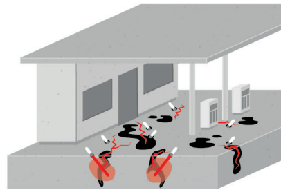
Sanierung von ölkontaminierten Rissen
