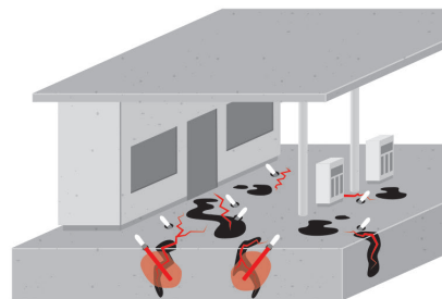
Sanierung von ölkontaminierten Rissen
