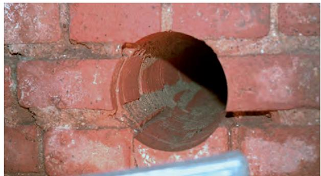
*Bohrkernentnahme an einem Ziegelmauerwerk*
