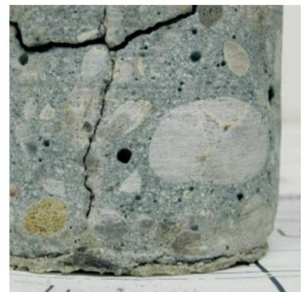
*Bohrkernentnahme: Feststellung von Hohlräumen, Rissverlauf, Feuchtezustand und Verunreinigungen*
