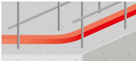
Abb. 4: Horizontale Eckverbindung
