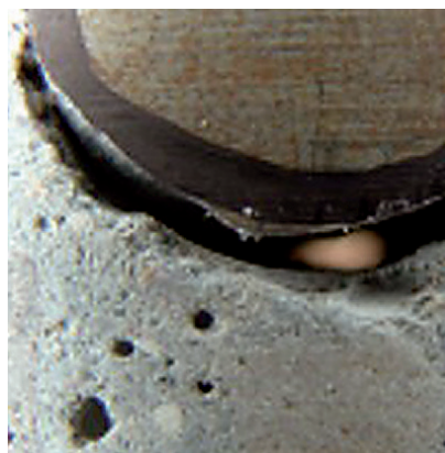
Bohrkernentnahme: Feststellung von Hohlräumen, Rissverlauf, Feuchtezustand und Verunreinigungen
