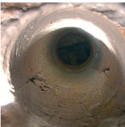
Bohrkernentnahme: Feststellung von Hohlräumen, Rissverlauf, Feuchtezustand und Verunreinigungen
