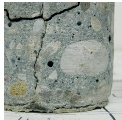
Bohrkernentnahme: Feststellung von Hohlräumen, Rissverlauf, Feuchtezustand und Verunreinigungen
