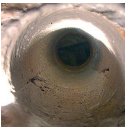
Toma de muestras de núcleos: Determinación de huecos, evolución de la grieta, condiciones de humedad y suciedad
