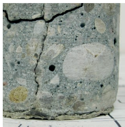
Toma de muestras de núcleos: Determinación de huecos, evolución de la grieta, condiciones de humedad y suciedad
