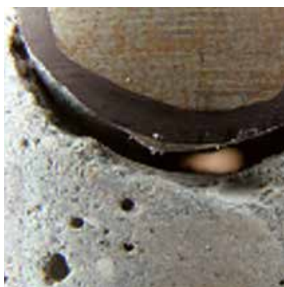
Puursüdamiku eemaldamine: tühimike, pragude kulgemise, niiskuseisundi ja saastumise kindlaksmääramine
