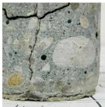
Puursüdamiku eemaldamine: tühimike, pragude kulgemise, niiskuseisundi ja saastumise kindlaksmääramine
