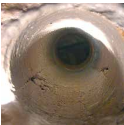
Puursüdamiku eemaldamine: tühimike, pragude kulgemise, niiskuseisundi ja saastumise kindlaksmääramine
