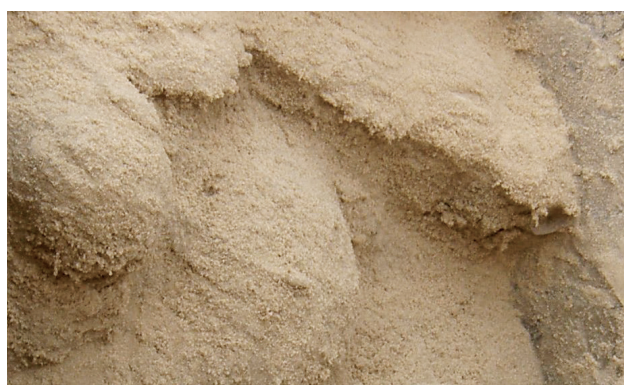
Joonis 6. Pärast injektsioontäitmist tekkinud liiva-geeli injektsioonkardina näide
