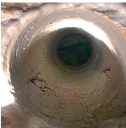
Lieriöporanäyte: huokoisuuden, halkamasyvyyden, kosteuden ja saastuneisuuden määrittäminen.
