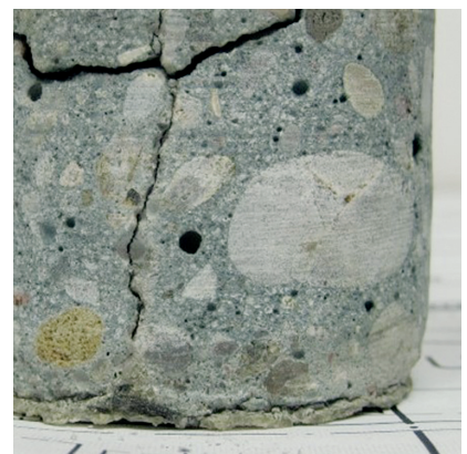
Lieriöporanäyte: huokoisuuden, halkamasyvyyden, kosteuden ja saastuneisuuden määrittäminen.
