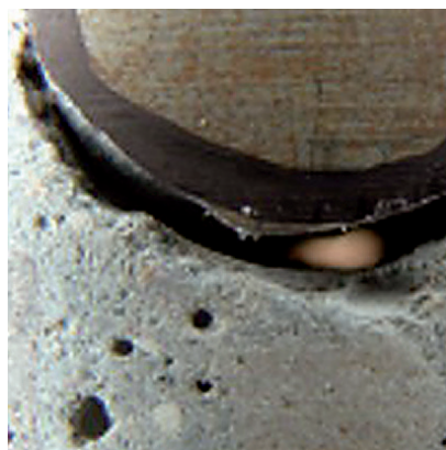
Lieriöporanäyte: huokoisuuden, halkamasyvyyden, kosteuden ja saastuneisuuden määrittäminen.
