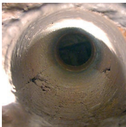
Prélèvement de carottes : détermination des cavités, de l'évolution des fissures, de l'état d'humidité et des impuretés
