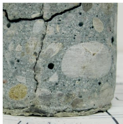
Prélèvement de carottes : détermination des cavités, de l'évolution des fissures, de l'état d'humidité et des impuretés
