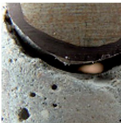
Prélèvement de carottes : détermination des cavités, de l'évolution des fissures, de l'état d'humidité et des impuretés
