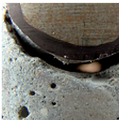
Carotaggio: Individuazione di cavità, andamento delle crepe, stato di umidità e contaminazione
