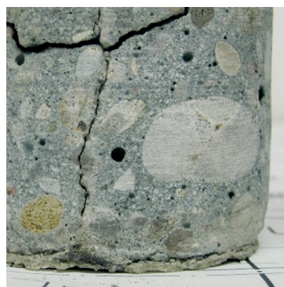
Carotaggio: Individuazione di cavità, andamento delle crepe, stato di umidità e contaminazione
