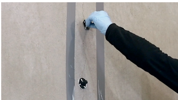
Fig. 3: Posicionando os bicos de adesão
