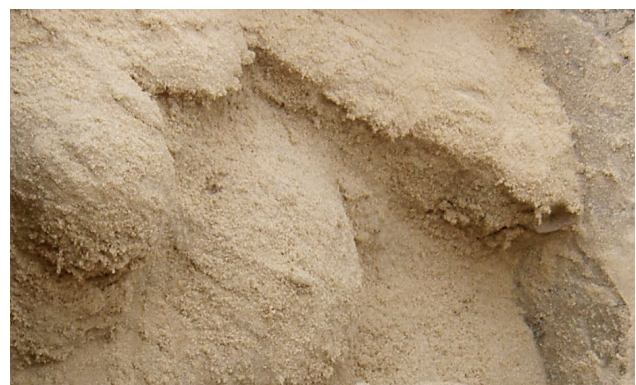
Fig. 6: Exemplo de cortina de gel após injeção
