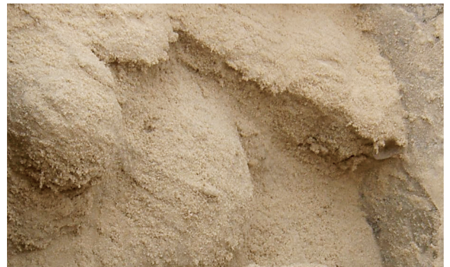
Şekil 6: Enjeksiyon sonrası jel perde örneği
