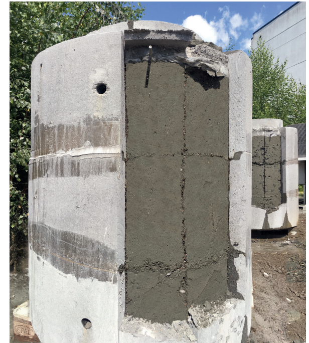
Mit WEBAC® HIS gefüllter Ringspalt (zur Veranschaulichung aufgeschnitten)
