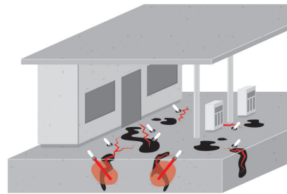
Sanierung von ölkontaminierten Rissen
