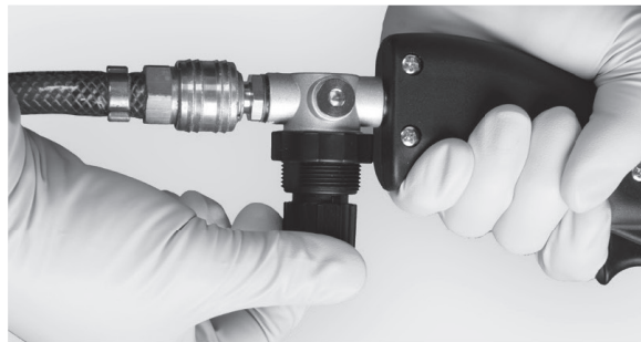
WEBAC QuickSet Pump mit Druckluftkompressor verbinden und Förderdruck mit Druckregelventil begrenzen
